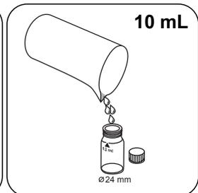
24-mm-Küvette mit **10 mL vorbereiteter Probe** füllen.
