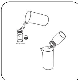
Pré-enzaguar a célula com a amostra de água.
