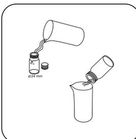
Prélevez la cuvette avec l'échantillon d'eau.
