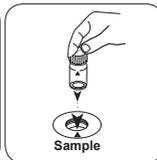
Die **Probenküvette** in den Messschacht stellen. Positionierung beachten.
