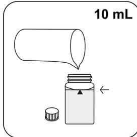
Riempire una cuvetta da 24 mm con **10 mL di acqua demineralizzata**.
