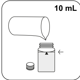
24-mm-Küvette mit 10 mL Probe füllen.
