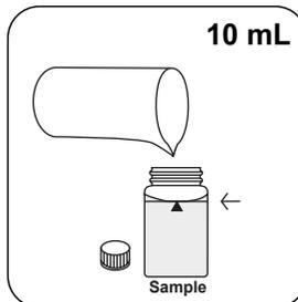
**10 mL Probe** in die Probenküvette geben.
