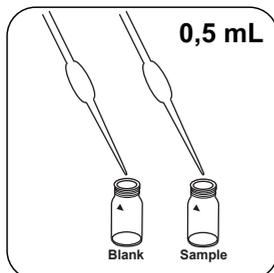
In jede Küvette **0,5 mL VARIO Sulfide 2 Lösung** geben.
