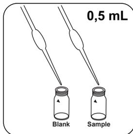
In jede Küvette **0,5 mL VARIO Sulfide 1 Lösung** geben.
