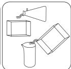
Remplissez la cuvette en y versant l'échantillon préparé.
