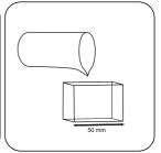
Remplissez une cuvette de 50 mm en y versant l'échantillon
