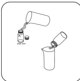
Предварительно промойте кювету пробой воды.
