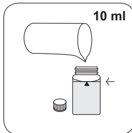
24-mm-Küvette mit 10 ml Probe füllen.
