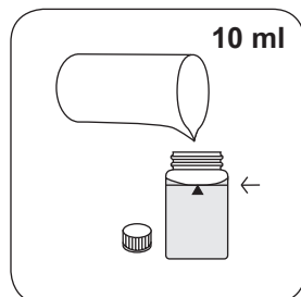
24-mm-Küvette mit 10 ml Probe füllen.
