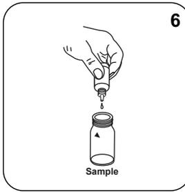
Adicionar **6 gotas DPD 1 Buffer Solution** à célula de amostra.
