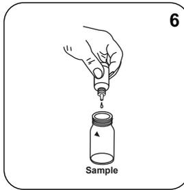
Ajoutez **6 gouttes de DPD 1 Buffer Solution** dans la cuvette réservée à l'échantillon.
