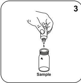
Ajoutez **3 gouttes de DPD 3 Solution** dans la cuvette réservée à l'échantillon.
