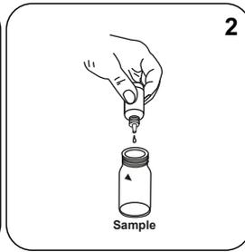
Ajoutez **2 gouttes de DPD 1 Reagent Solution** dans la cuvette réservée à l'échantillon.
