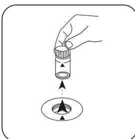
Prelevare la cuvetta dal vano di misurazione.
