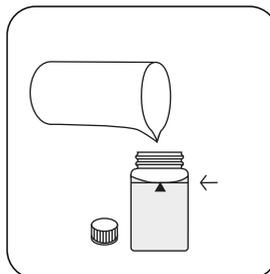
Encher a célula até à **marca de 10 mL** com a amostra.
