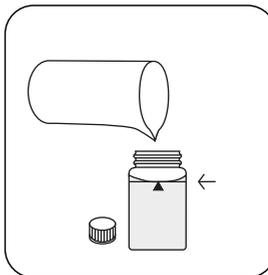
Encher a célula até à **marca de 10 mL** com a amostra.
