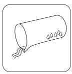
Ein geeignetes Probengefäß mit etwas Probe spülen und bis auf einige Tropfen entleeren.
