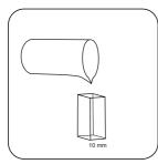
Eine 10-mm-Küvette mit Probe füllen.
