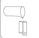
Eine 10-mm-Küvette mit Probe füllen.
