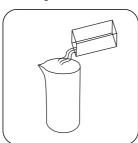
Die Probelösung vollständig Eine DPD No.3 HR in das Probegefäß zurück- Tablette zugeben. schütten.
