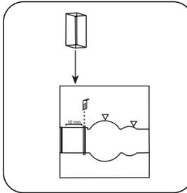
Posizionare la **cuvetta del campione** nel vano di misurazione. Fare attenzione al posizionamento.
