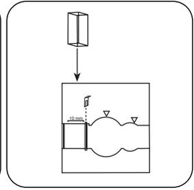
Posizionare la **cuvetta del campione** nel vano di misurazione. Fare attenzione al posizionamento.
