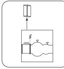
Retirez la cuvette de la chambre de mesure.
