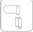
Remplissez une cuvette de 10 mm en y versant l'échantillon.
