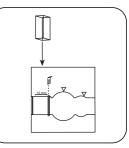
Placez la cuvette réservée à l'échantillon dans la chambre de mesure. Attention à la positionner correctement.
