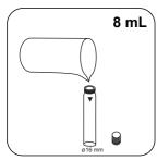
16-mm-Küvette mit 8 mL Probe füllen.
