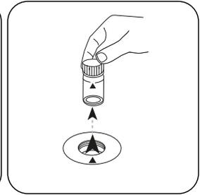
Prelevare la cuvetta dal vano di misurazione.
