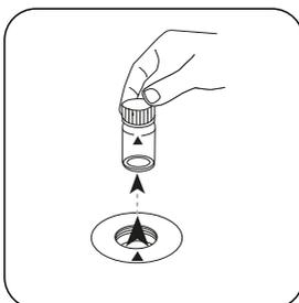
Prelevare la cuvetta dal vano di misurazione.
