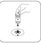
Prelevare la cuvetta dal vano di misurazione.
