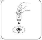
Prelevare la cuvetta dal vano di misurazione.
