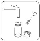
Pulire a fondo la cuvetta e il coperchio della cuvetta.
