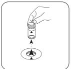
Küvette aus dem Messschacht nehmen.
