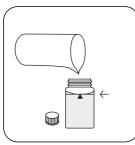
Küvette bis zur 10-mL-Marke mit der Probe auffüllen.
