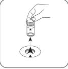
Küvette aus dem Messschacht nehmen.
