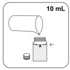
24-mm-Küvette mit 10 mL Probe füllen.
