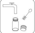
Die Küvette und den Küvettendeckel gründlich reinigen.
