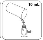
Eine zweite Küvette mit 10 mL Probe füllen.
