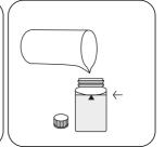
Küvette bis zur 10-mL-Marke mit der Probe auffüllen.
