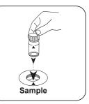
Die **Probenküvette** in den Messschacht stellen. Positionierung beachten.
