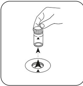
Prelevare la cuvetta dal vano di misurazione.
