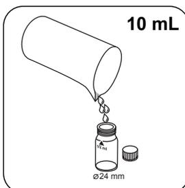
Riempire una **seconda cuvetta** con **10 mL di campione**.
