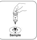
Placez la cuvette réservée à l'échantillon dans la chambre de mesure. Attention à la positionner correctement.
