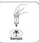
Placez la cuvette réservée Appuyez sur la touche à l'échantillon dans la chambre de mesure. Attention à la positionner correctement.
