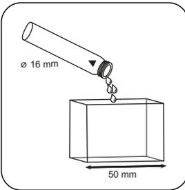
Remplissez la cuvette de 50 mm de l'échantillon préparé.
