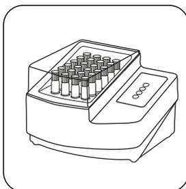
Fractionnez la(les) cuvette(s) dans un thermoréacteur préchauffé pendant **120 minutes à 100 °C**.
