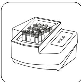
Disgregar la(s) cubeta(s) en el termoreactor precalentado durante **120 minutos a 100 °C** .
