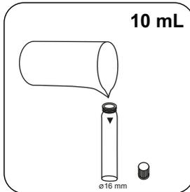
Remplissez une cuvette de 16 mm de **10 mL d'échantillon**.
