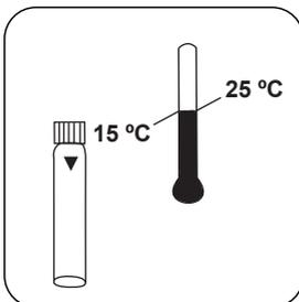
Laissez la(les) cuvette(s) refroidir à température ambiante.
