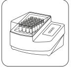
Растворите (содержимое) кюветы в течение 120 минут при температуре 150 °C в термореакторе.
