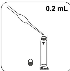
Immettere **0.2 mL di acqua demineralizzata** nella cuvetta zero.
