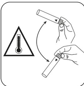
Miscelare il contenuto capovolgendo con cautela. **Attenzione: sviluppo di calore!**
