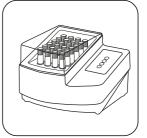
Растворите (содержимое) кюветы в течение 120 минут при температуре 150 °С в термореакторе.
