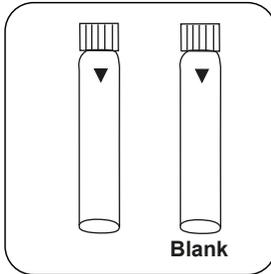
Zwei **Reagenzküvetten** bereitstellen. Eine als Nullküvette kennzeichnen.
