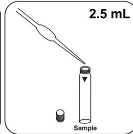
**2.5 mL Probe** in die Probenküvette geben.
