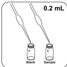
在每个比色杯中加入 0.2 mL Vario DEHA 2 Rgt 溶液。
