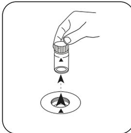
Prelevare la cuvetta dal vano di misurazione.
