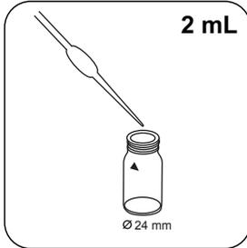
Immettere **2 mL di campione** e **8 mL di acqua demineralizzata** nella cuvetta del campione.
