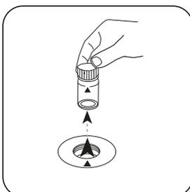
Prelevare la cuvetta dal vano di misurazione.
