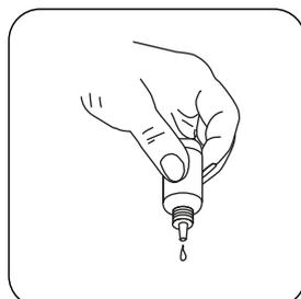
Tenere le bottiglie contagocce in posizione verticale e introdurre, premendo lentamente, gocce della stessa dimensione nella cuvetta.
