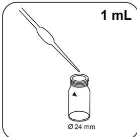
**1 mL (25 Tropfen) Polyacrylat Puffer A1 Lösung** in die Probeküvette geben.
