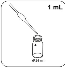
**1 mL (25 Tropfen) Polyacrylat Fällmittel A2 Lösung** in die Probenküvette geben.
