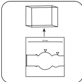
Extraer la **cuve**ta del compartimiento de medición.
