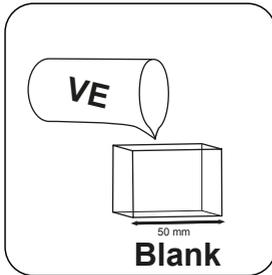
Llenar la **cuve**ta de 50 mm con **agua desionizada**.
