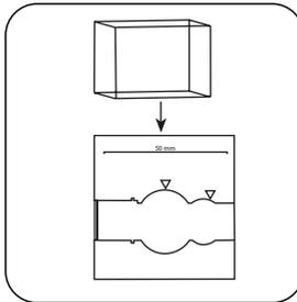
Poner la **cuve**ta de **muestra** en el compartimiento de medición. ¡Debe tenerse en cuenta el posicionamiento!
