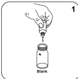
Adicionar **1 gota Vario ALUMINIUM ECR Masking Reagent** à célula zero.
