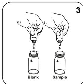
Dans chaque cuvette, versez **3 gouttes de solution Chloride-51**.
