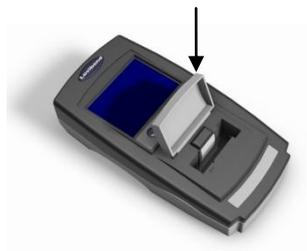
3 - Cierre la tapa de la muestra y pulse la tecla de cero en el teclado o en la pantalla.
