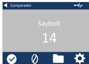
10 - Compare el resultado del instrumento con el valor que aparece en la etiqueta del líquido de validación para saber si está dentro de las tolerancias especificadas.
