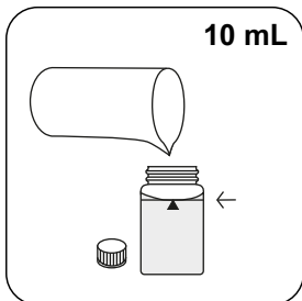
Llenar la cubeta de 24 mm con 10 mL de muestra .
