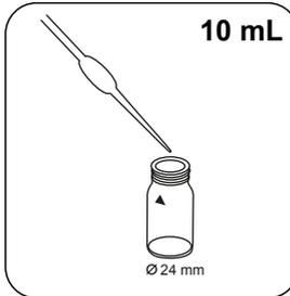
Llene la cubeta cero con **exactamente 10 mL** de agua desionizada..
