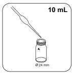
Adicionar **exacta 10 mL de amostra** à célula de amostra.
