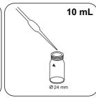
Encher a cubeta de zero com exatamente 10 mL de água desionizada.
