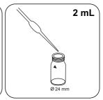
Adicionar exatamente 2 mL SPADNS AF reagent solution de reagente.
