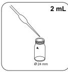
Adicionar à célula de 24 mm exatamente 2 mL SPADNS AF reagent solution .
