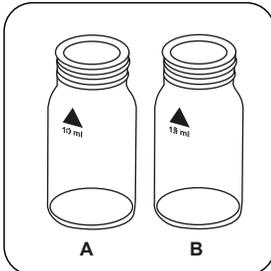
Préparer deux cuvettes propres de 24 mm. Marquer l'une comme étant la cuvette Échantillon zéro et l'autre comme étant la cuvette Échantillon.
