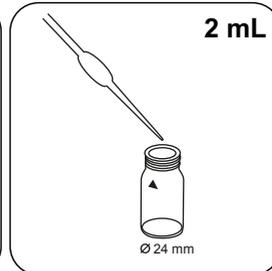
Ajoutez une **quantité exacte de 2 mL de réactif SPADNS AF reagent solution.**
