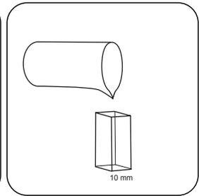
Eine 10, 20 oder 50 -mm-Küvette mit Probe füllen.
