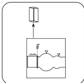
Prelevare la **cuvetta** dal vano di misurazione.
