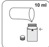
24-mm-Küvette mit **10 ml Probe** füllen.
