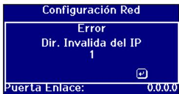
En caso de error al introducir la dirección IP, se mostrará esta pantalla de mensaje. Pulse ↵ para salir de la pantalla y reintroduzca el valor requerido.
