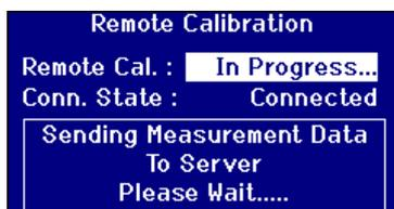
Una vez se han medido todas las soluciones, los datos de la medición se envían al servidor de calibración para la verificación.
