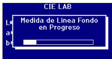
Cuando la medición de línea de base ha terminado, el instrumento volverá a la pantalla que se mostraba antes de pulsar **CERO**.
