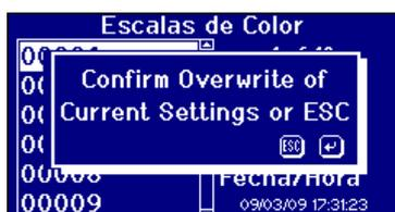
Si la configuración actual del instrumento es diferente de la configuración de la medición almacenada, se requerirá una confirmación para cambiar la configuración a la de la medición almacenada.
