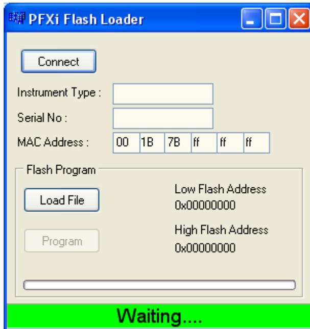
La barra de estado verde indica que el programa ha entrado correctamente en comunicación con el instrumento.
