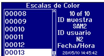
El nuevo valor ID de muestra para la medición aparece en el lado derecho del visor.
