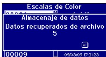
El software mostrará una pantalla de confirmación para indicar que la medición se ha recuperado correctamente.
