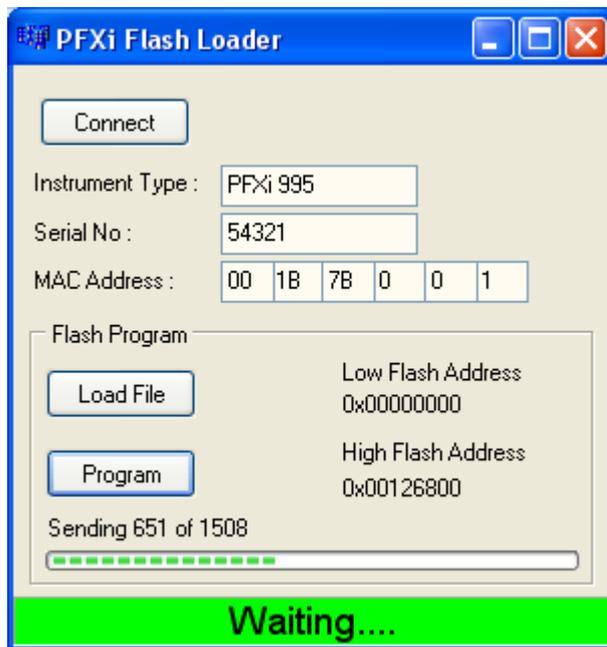
Cuando haya finalizado la programación, la pantalla LCD mostrará 'Reinicie el instrumento Actualización realizada' – Apague el instrumento y reinicielo. Confirme que la versión del programa es correcta en la pantalla de presentación del instrumento (debe corresponder con la parte de la versión del nombre del archivo).
