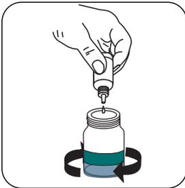
**Polyamine Titrant P4/2** tropfenweise der Probe zugeben bis die Färbung von **blau** nach **grau**, in der unteren Schicht, umschlägt (**Wenn die Schicht P1/M rosa ist, wurde der Endpunkt überschritten.**).
