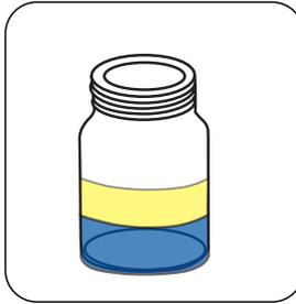
Probe stehen lassen, bis sich die Phasen getrennt haben. Wenn irgendein Produkt vorhanden ist, sollte sich in der unteren Schicht eine blaue Farbe entwickeln.
