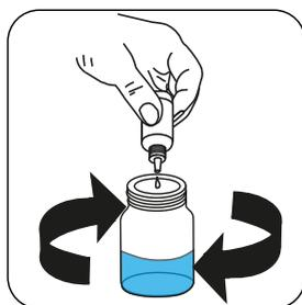
Ajoutez au goutte à goutte **Free Chlorine LR Titrant FCL2** ou **Free Chlorine HR Titrant FCL3** au échantillon jusqu'à obtention d'une coloration **incolore / jaune pâle à blue.**
