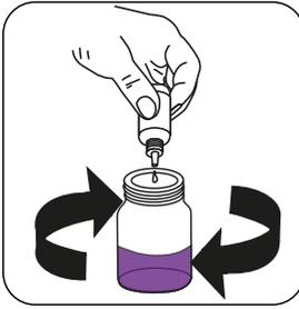
Adicionar **Phosphonate Titrant P5** gota a gota à amostra até a coloração passar de **cinzento a violeta**.
