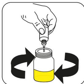
Adicionar **suficiente** gotas **Phosphonate Neutraliser P1/2** até obter uma cor **amarelo**.
