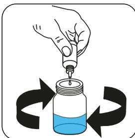
Añadir gota a gota **Sulphite Titrant S2** en la muestra hasta que adquiera una coloración de **incoloro a azul**.
