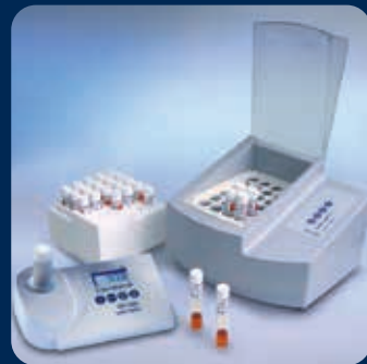
Estación de medición DQO MD200
