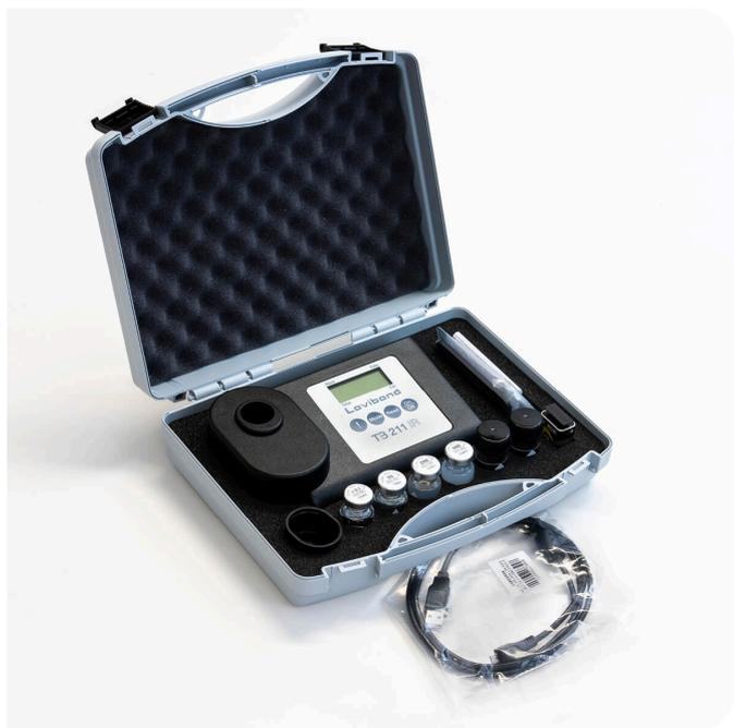
Instrumento compacto para medición de turbidez por infrarrojos Lovibond® TB 211 IR, para un análisis in situ rápido y preciso. Mediciones según lo descrito en EN ISO 7027, refracción de luz en un ángulo de 90°.
