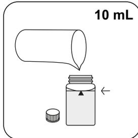
Remplissez une cuvette de 24 mm de **10 mL d'échantillon**.
