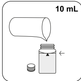
24-mm-Küvette mit 10 mL Probe füllen.
